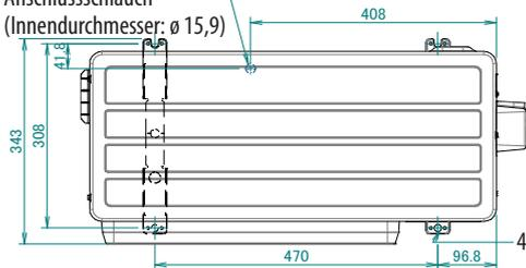
4 Bohrungen für Ankerschrauben (M8 oder M10)
